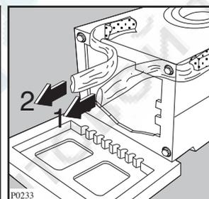
5. Поставьте машину в вертикальное положение и удалите остальные два болта с задней панели.
